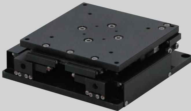
スライド部分には中間プレートを上下2枚のプレートで挟み込む「予圧型ダブルスライド」構造を採用。各プレートの上に多数のボールが配置され、スムーズな平面転がり運動を可能にしています。また3つのアクチュエータを同一平面上に配置した為、低重心・超薄型シンプル構造を実現。装置の小型化に貢献します。
