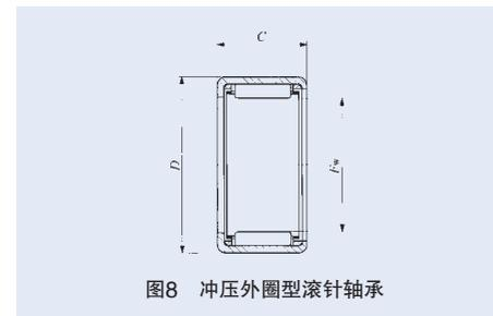
图8 冲压外圈型滚针轴承
