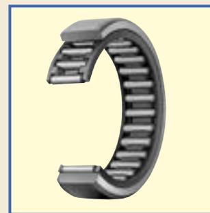
这是内圈、外圈与滚针保持架组合在一起的轴承，内外圈能方便地分离，结构简单，精度高，而且可以选择这些零件进行搭配，因而可以自由选择径向间隙。
