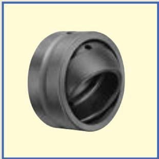
这是使内外圈作球面接触的自动调心型滑动轴承。能够同时承受大径向负荷和双向的轴向负荷。
