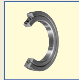
这是在内圈和外圈之间垂直交叉配置圆柱滚子的高刚性、紧凑结构的轴承。一个轴承能够同时承受径向负荷、轴向负荷及力矩负荷等各个方向的负荷。
